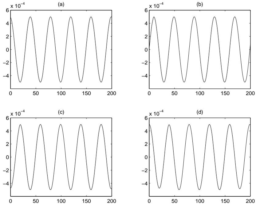
Figure 3: Propagation of monochromatic wave: (a)  $u_n(0)$ ; (b)  $u_n(10)$ ; (c)  $u_n(20)$ ; (d)  $u_n(40)$ .
