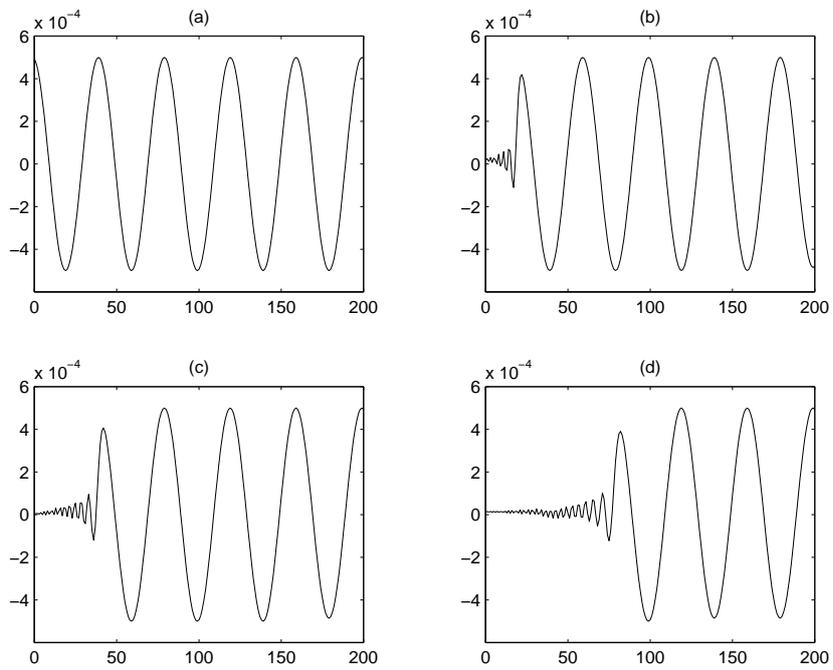
Figure 4: Attenuation of monochromatic wave: (a)  $u_n(0)$ ; (b)  $u_n(20)$ ; (c)  $u_n(40)$ ; (d)  $u_n(80)$ .
