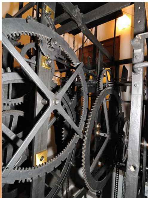
Fig. 7 天文钟详图中小齿轮的位置。图中的扣子卡在大齿轮的十八时与十九时之间的齿距上。
