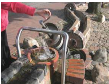
图 17 阿基米德式螺旋抽水机
