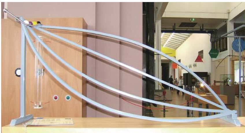
图17 极大极小问题的经典问题之一:最速降线问题(一个质点从等高处沿着什么样的曲线下降所需时间最短,图为德国曼海姆市技术劳动博物馆展品)
